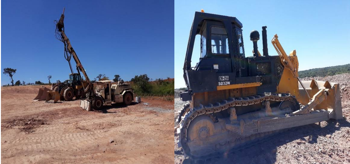
Photo 10: Chargeuses et niveleuse à chaînes et foreuse pour la mine souterraine
